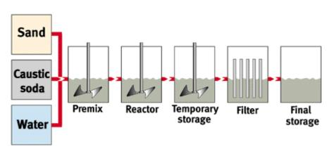
$2 \text{ MOH } + \text{ x } \text{SiO}_2 \rightarrow \text{ M}_2\text{O} \bullet \text{ x } \text{SiO}_2 + \text{ H}_2\text{O}$
